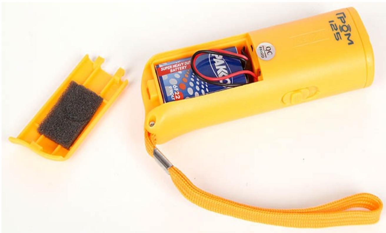
Чтобы проверить работоспособность прибора — активируйте режим фонаря, переведя переключатель в соответствующее положение, — если светодиоды загорятся, значит, устройство функционирует нормально. Если светодиоды горят слабо, необходимо вставить новый элемент питания. Тусклое свечение светодиодов указывает, что сила ультразвука будет слабой и малоэффективной.
