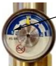
Рисунок 23 – Манометр на редукторе баллона
