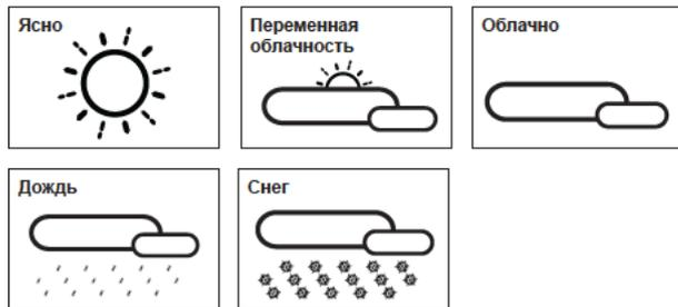
*Примечание: Пиктограмма «снег» отображается в случае падения атмосферного давления (ухудшения погоды) при наружной температуре ниже 0°C.*
