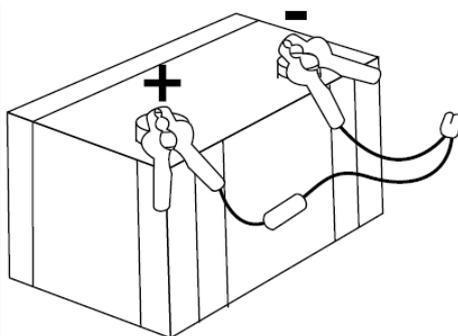
2. Вставьте другой конец адаптера «крокодилы» в выход устройства для запуска автомобильного аккумулятора 12В.
