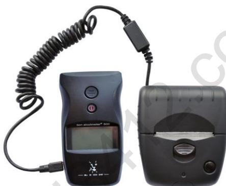
Рисунок 1 – Анализатор с подключенным внешним принтером
