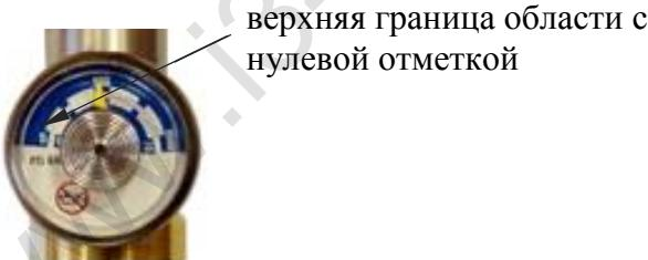
Рисунок 19 – Манометр на редукторе баллона
