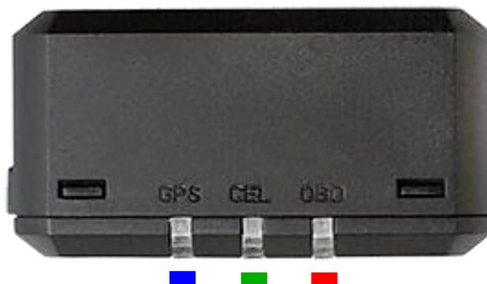
Для быстрой проверки качества приема сигналов GPS и GSM, а так же состояния устройства используются светодиодные индикаторы. Статус определяется по характеру их свечения:
