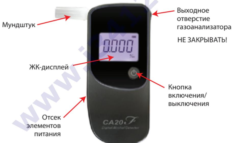
Устройство предназначено для измерения содержания паров алкоголя в выдыхаемом воздухе. Пожалуйста, внимательно ознакомьтесь с данной инструкцией перед началом использования устройства. Пожалуйста, не садитесь за руль после употребления спиртных напитков.
