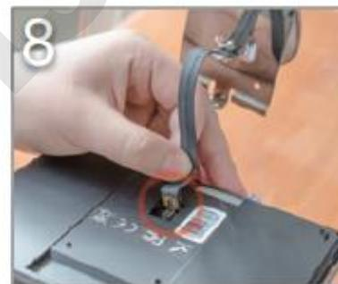
8 Подключите кабель в разъем на задней части монитора.
