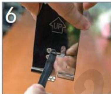
6 Соедините круглый конец верхнего и нижнего шлицев на кронштейне 2 болтами на камере, сдвиньте кронштейн к камере.
