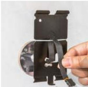
9. После того, как Вы провели кабель под резинкой, подключите его к разъему в задней части монитора.
