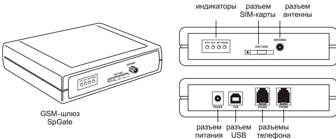
Рисунок 2.1. GSM-шлюз SpGate
