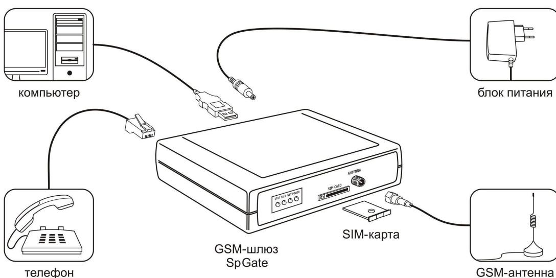
Рисунок 6.1. Подключение шлюза SpGate
