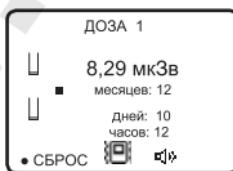
Одновременное нажатие кнопок «А» и «В», во время индикации экрана «ДОЗА» обнуляет накопленную дозу.
