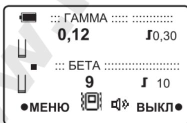
Пиктограммы количества выполненных циклов измерений « » (стр14, поля 3, 5) позволяют наглядно определить количество циклов измерений и очень полезны для фиксации места и момента резкого изменения мощности дозы или плотности потока бета-излучения, так как в этом случае пиктограмма « » изменится на пиктограмму « », что легко заметить. При этом оценка автоматически начинается с
