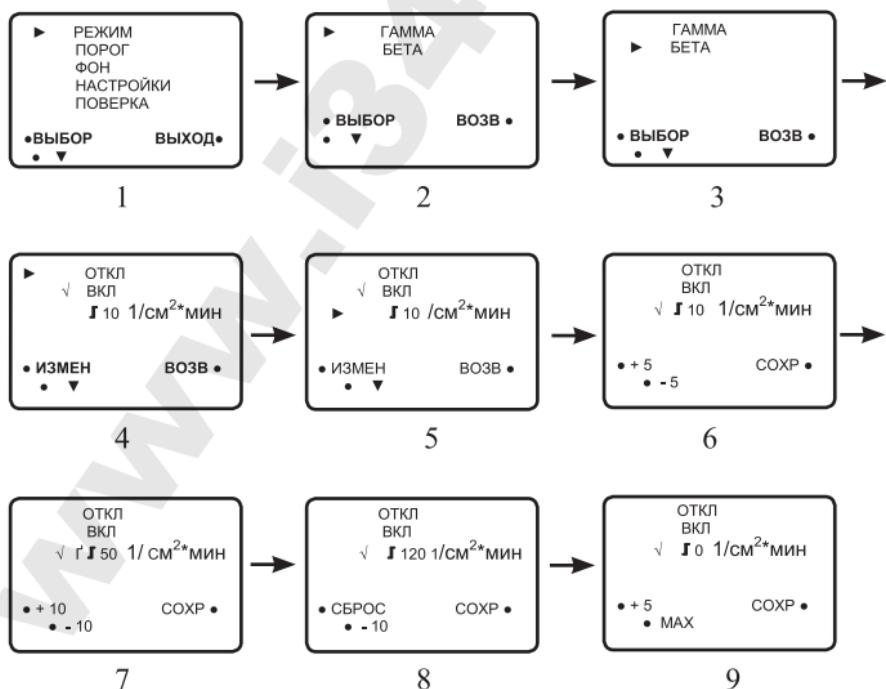
Для установки порога необходимо войти в режим «МЕНЮ», выбрать раздел «ПОРОГ» (экран 1), выбрать вид излучения, для которого устанавливается порог (экраны 2, 3), и войти в экран установки величины порога (экран 4).
