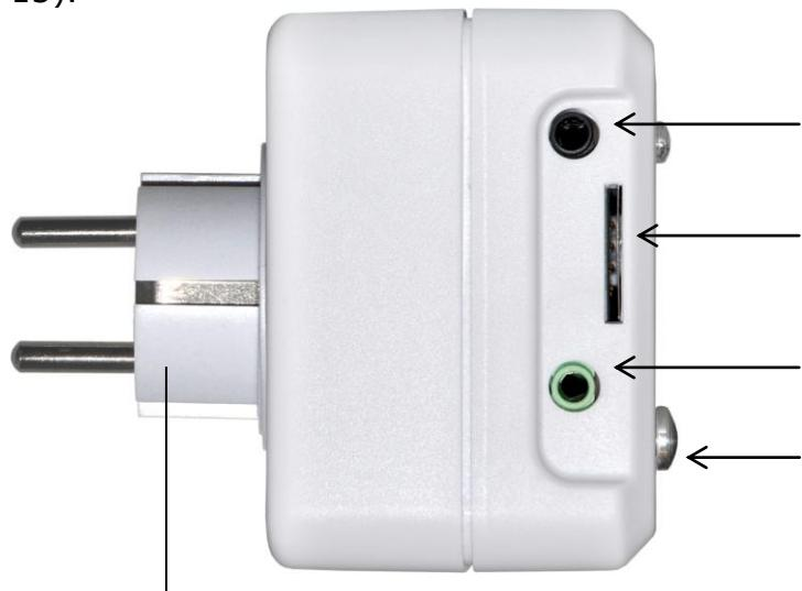
Разъем для подключения устройства iSocket GSM 706/707 во внешнюю настенную розетку для питания самого устройства и подключенных к нему приборов.
