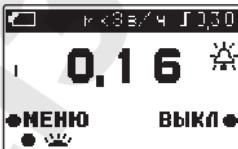
\* Короткий цикл наблюдения равен половине полного цикла, и предназначен для быстрого получения предварительных результатов. Первый достоверный результат после включения изделия выводится на дисплей через 1 - 26 сек в зависимости от МЭД и отображается пиктограммой «|■|».
