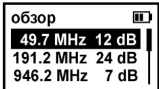
В случае пропадания сигнал удаляется из списка не сразу, а с задержкой примерно 10 секунд, в это время на дисплее отображается последнее ненулевое значение уровня сигнала.
