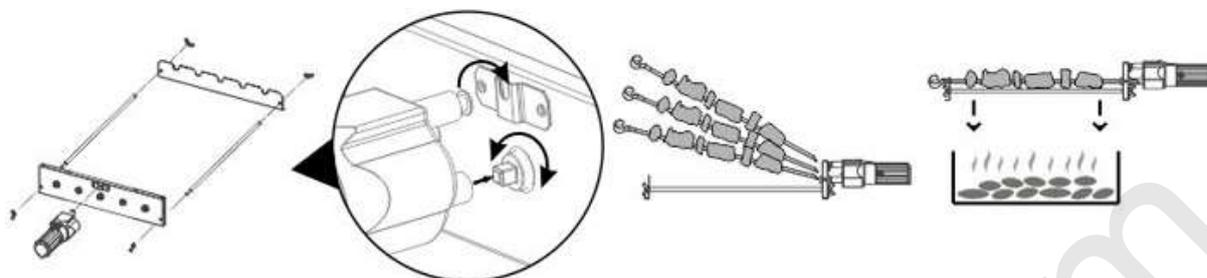
1. Изделие собирается в виде рамки, состоящей из двух стяжек, держателя для шампуров и редуктора. Установка мотора осуществляется в последнюю очередь. Для этого нужно вставить фиксатор мотора в зацеп на редукторе. После этого надеть мотор на ось вращения редуктора. Возможно несовпадение оси мотора и оси вращения редуктора (из-за квадратного сечения). В этом случае необходимо повернуть ось редуктора до положения полного совпадения с осью мотора.
