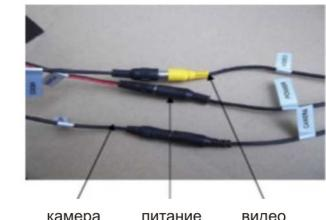
В первую очередь подключите аккумулятор к кабелю питания экрана, затем подключите кабель вывода питания и входные AV-разъемы.
