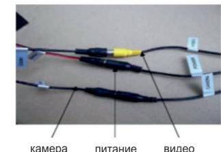
В первую очередь подключите аккумулятор к кабелю питания экрана, затем подключите кабель вывода питания и входные AV-разъемы.
