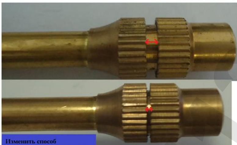
Изменить способ распыления можно, меняя расположение распыляющей насадки.
