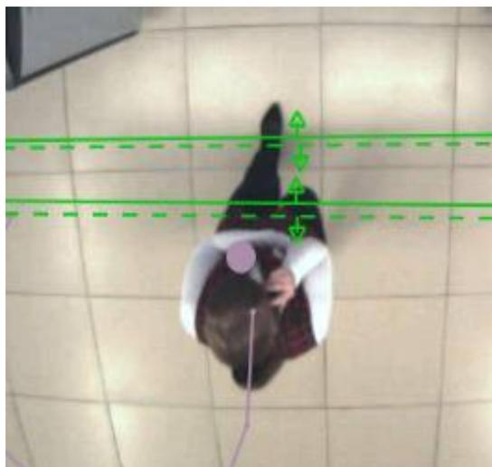
3D счетчик использует алгоритм чувствительности к 3D облаку. Как только в кадре появляется посетитель, счетчик фиксирует возмущение 3D сцены, определяет у посетителя положение головы и сопровождает его в поле зрения. Одновременное ведение плотного потока посетителей
