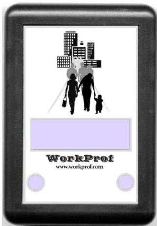
У приёмника снизу находятся два отверстия с кнопками слева направо Рис. 2. («СБРОС», «ВЫВОД ПОСЛЕДНЕГО ЗНАЧЕНИЯ ДО БРОСА»/«ТЕСТ»)
