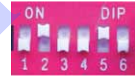
Bloque con 6 conmutadores DIP
