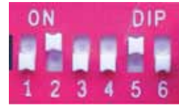
Bloc comprenant les 6 commutateurs DIP
