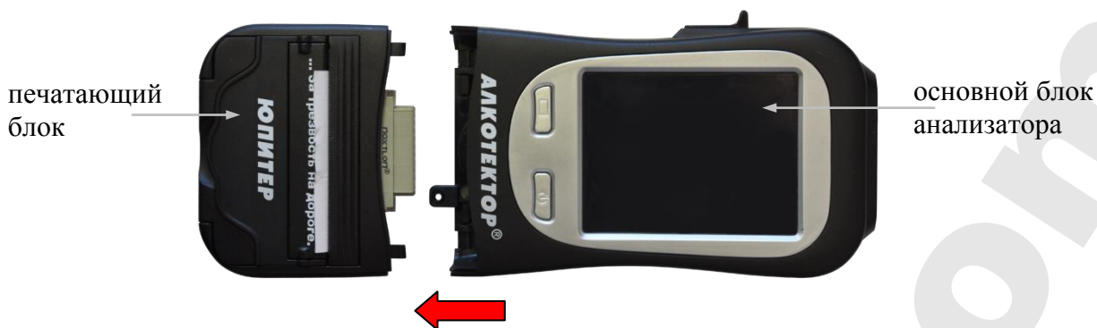
Рисунок 31 – Отсоединение печатающего блока
