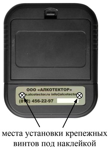
Рисунок 29 – Отсоединение заглушки от приемника Bluetooth
