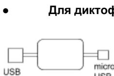
Подключите кабель-адаптер ( входящий в комплект поставки ) к USB-разъёму диктофона, далее подсоедините его к USB-порту ПК, либо любому зарядному устройству USB(к примеру от смартфона) с выходным напряжением 5 вольт и током не менее 500mA. Во время зарядки на адаптере горит красный светодиод, по завершению процесса загорится зеленый. При этом Переключатель питания должен находиться в положении "On" и карта microSD должна быть установлена в слот.
