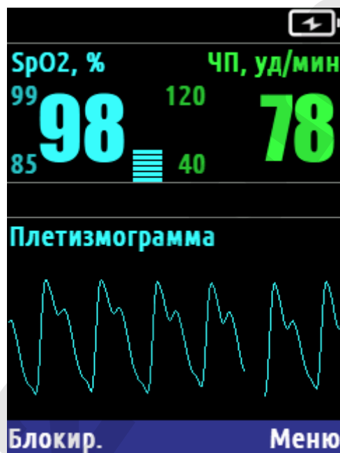
Рисунок 1.8 – Регистрация ФПГ с отображением графика
