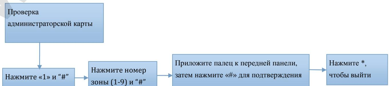
Номер зоны используется, чтобы управлять доступом отпечатками пальцев. Например, для разных отделов в одной компании выделяются разные зоны для доступа.
